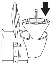
本体上部を開け、内部フィルターをセットします。詳しくはP6「内部フィルター部分の取扱方法」をご参照ください。
