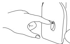
電源スイッチオフを確認しプラグをコンセントに差し込み、電源スイッチをオンにしてください。抽出開始のアラームが鳴り、電源スイッチのランプが赤く点灯した後、しばらくしてコーヒーの滴下が始まります。
