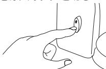
抽出終了1分でアラームが鳴り、自動的に電源が切れます。安全のため、手動で電源スイッチをオフの位置に戻してください。コーヒーの滴下が続いていることもあるので、コーヒーが落ちこぼったことを確認してからゆっくり保温ポットを引き抜きます。
