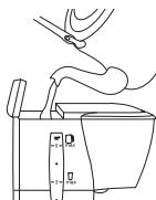
杯数分の水を水槽タンクに入れて水槽タンクフタを閉じてください。水槽タンクの目盛りはコーヒーのでき上がり量を示します。
