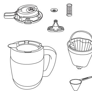
水槽に目盛「5」まで水道水を入れ（図1）、フィルターペーパー、コーヒー粉を入れずに（図2）、P7「ご使用方法：5～9」に従いスイッチを入れます。水槽タンクの水がなくなり、アラームが鳴ると電源が自動的に切れて終了です。スイッチをオフの位置に戻してください。
