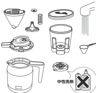
水ですすぎ洗いしてください。浄水フィルター以外のもので汚れがひどい場合は、中性洗剤を水またはぬる湯で薄め、柔らかいスポンジを使用して軽く洗ってください。その後、洗剤が残らないようにすすぎ洗いをしてください。
